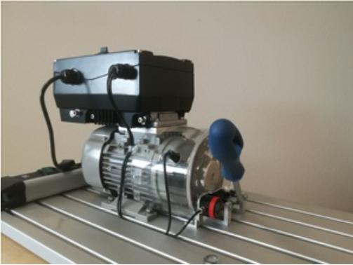
Der Micro-Controller sendet die Daten in Echtzeit über IoT orientierte Kommunikation, via Leitung oder WLAN, an die Datenerfassungs- und Verwaltungsplattform ifakFAST. Damit stehen die Daten weiteren IoT Komponenten zur Verfügung.
