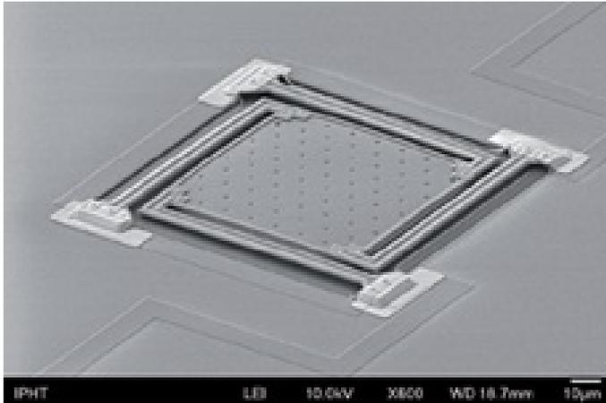
Das Leibniz-Institut für Photonische Technologien entwickelt und fertigt hochdetektive thermoelektrische Strahlungssensoren auf der Basis von V-/VI-Verbindungshalbleitern.
