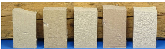
Bild 2 - Möglichkeiten der Farbgebung des verwendeten Holzergänzungsmörtels
