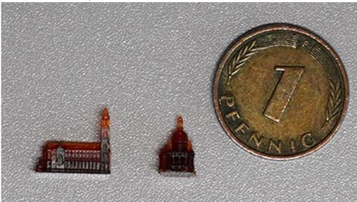
Es werden Mikroflussszellen sowie weitere 3D-Modelle ausgestellt, die den aktuellen Stand im  $\mu$ SL-3D-Druck verdeutlichen.
