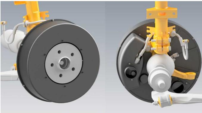
Die Erfindung dient zur Probenahme und Bereitstellung von Bremsstaubpartikel am Fahrzeug und ermöglicht dadurch die Messung und Klassifizierung der je Fahrzustand und Fahrstrecke emittierten Partikel.
