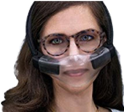
Der SECURER ist eine neuartige Zuluft-sterilisierende Atemmaske gegen zukünftige Pandemien. Diese beinhaltet eine miniaturisierte mehrstufige Desinfektionsstrecke, die Atemluft reinigt und sowohl von bakteriellen als auch viral Verunreinigungen befreit. Den Kern des Desinfektionsverfahrens bildet dabei eine "Lichtkammer" unter Verwendung von extrem leistungsstarken UV-C-LED's. Diese zerstören im Volumenstrom befindliche Mikroorganismen auf molekularer Ebene.
