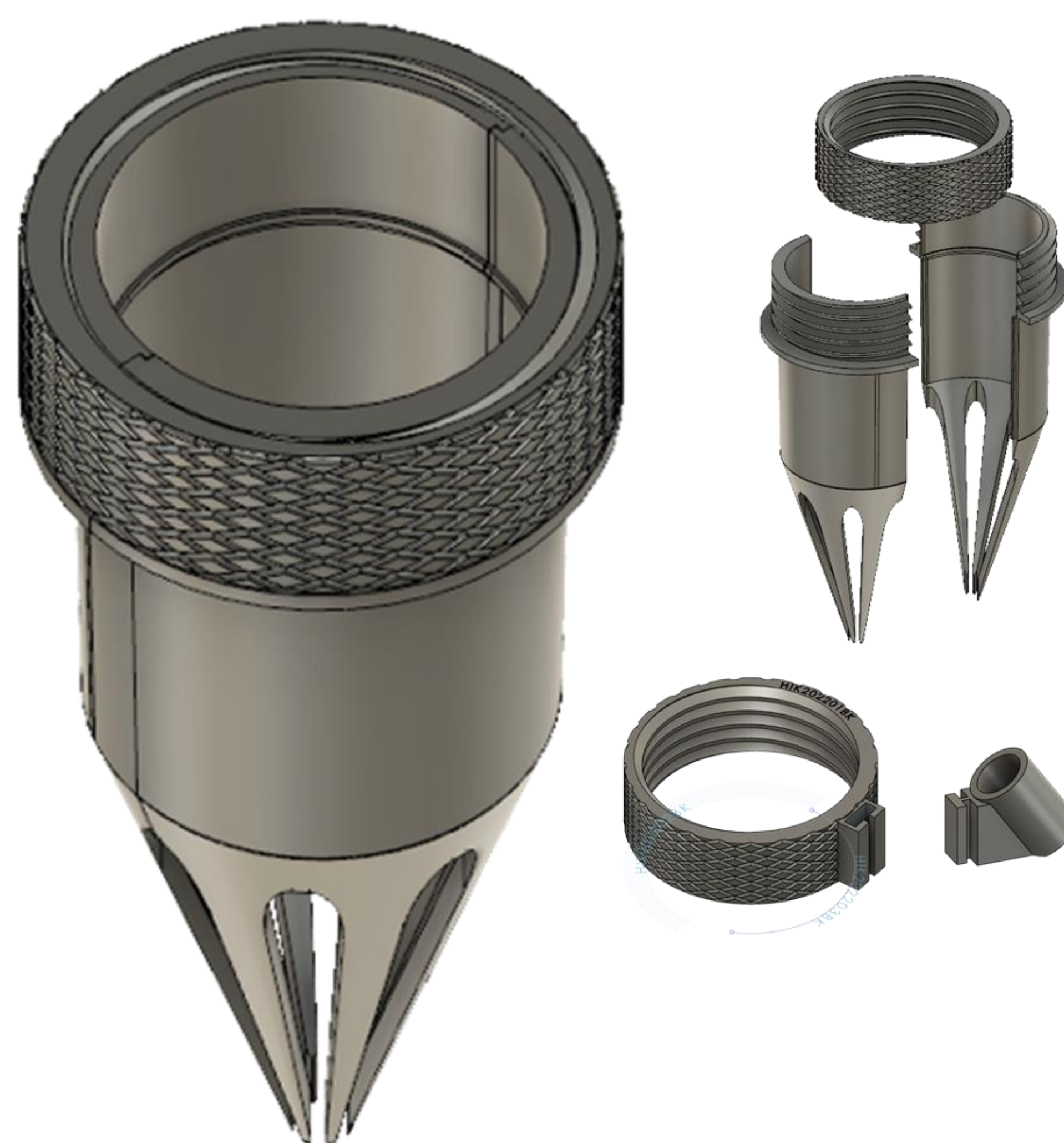
Abb. 2: Der Korb für hydroponische Anlagen umfasst zwei Korbhalbteile, einen Schraubverschluss (rot) mit einer Adapteraufnahme. Die Adapteraufnahme kann einen Adapter (blau) aufnehmen.
