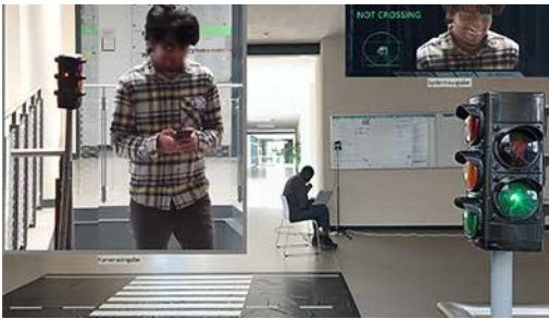
Das System zur Fußgängerabsichtsschätzung für Advanced Driver-Assistance Systems (ADAS) analysiert die Gesichtsausdrücke der Fußgänger, um ihre zukünftigen Absichten abzuschätzen.
