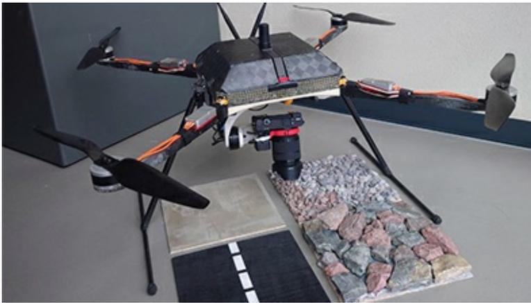
Drohnenkonzept zur Erweiterung der Sichtfelder in der Fahrzeugassistentz.
