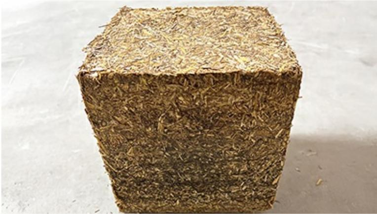
Nutzung von Mikrowellenstrahlung für das Herstellen von Mauersteinen aus Stroh
